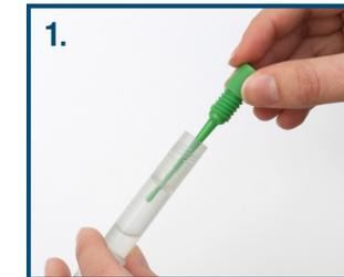
Halten Sie das Probenröhrchen mit der grünen Kappe nach oben und drehen Sie die grüne Kappe mit dem Spiralstab aus dem Probenröhrchen heraus.
